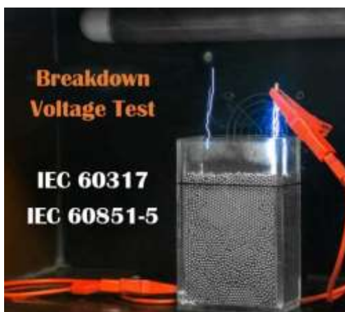
Breakdown voltage test « STANDARDS: IEC 60851-5 »
